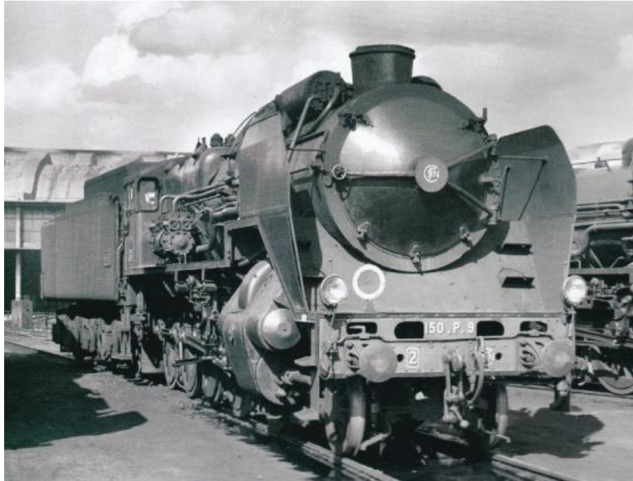
Figure 11 - Un format bien réduit pour une machine capable de tracter 2000 t à 70 Kmh.
