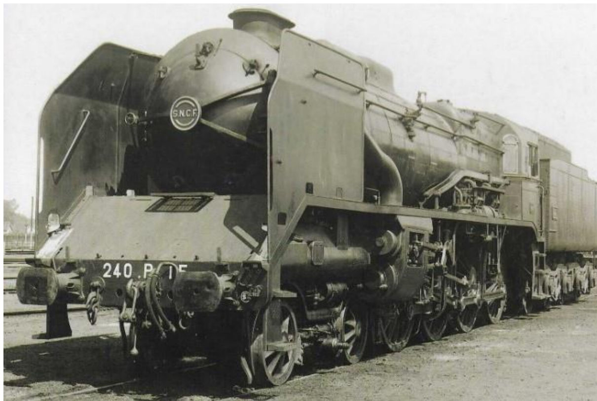
Figure 10 - 240 P 15 transformée à partir d'une Pacific 4500 du PO (1941).
